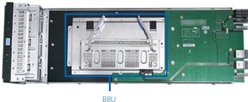
BBU 能够在系统外部供电失效时提供后备电源支持，以保证存储阵列中业务数据的安全性。系统电源供电正常时，BBU 处于备用状态；两个电源模块供电均失效（故障或是停电）时，BBU 可以继续给对应的控制器供电，确保系统将 Cache 里的脏数据和系统配置信息写入系统盘，保证数据不丢失。
