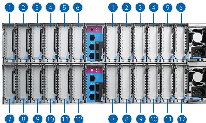
PCIe 插槽支持使用 SAS 卡、FC 卡、以太网卡、ACC 卡、NTB 卡，用于连接后端存储或者前端的应用主机等。PCIe 卡的优先级：ACC 卡 > NTB 卡 > SAS 卡 > FC 卡 > 以太网卡。
